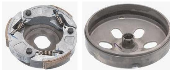
Gambar 4. *Centrifugal clutch disc* dan *clutch housing*
